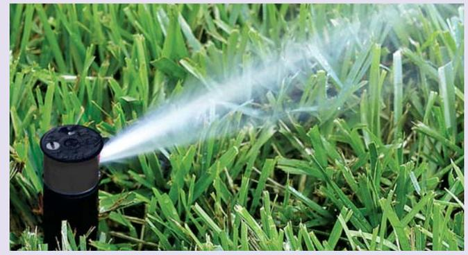
Il MiniPro è un irrigatore a turbina idraulica lubrificata ad acqua in grado di sviluppare gittate variabili da m.5,1 a m. 9,1 con pressioni da 2,1 a 3,4 bar e portate da 2,84 a 12,5 l/min. Il MiniPro è fornito di 5 differenti ugelli codificati ed intercambiabili. L'inclinazione dei bocagli è di 26°. L'irrigatore è dotato di una vite di regolazione del getto in acciaio inossidabile.
